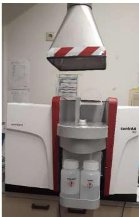
**Figure 3.7: Contra AAS graphite furnace (HR-CS- AAS 800 G; Jena Analytik).**
